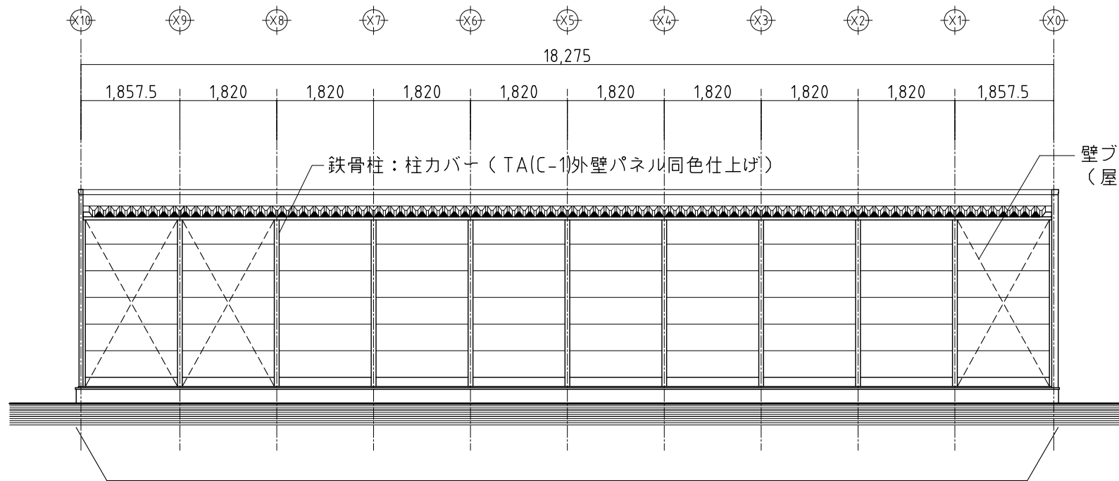
TA(C-1)外壁パネル (カラー鋼板t=0.35 サンドイッチ落とし込み式)
