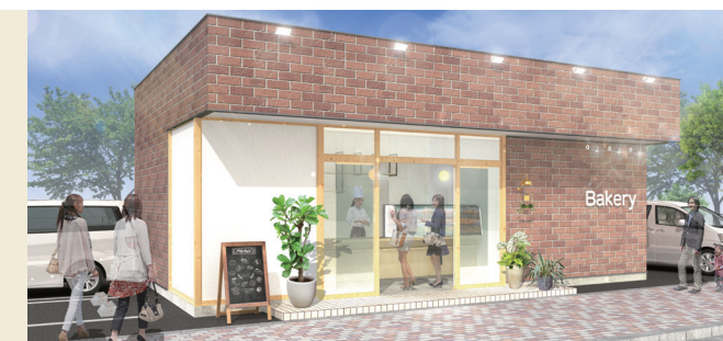
TA(C-1)外壁パネル(カラー鋼板t=0.35 サンドイッチ落し込み式)
